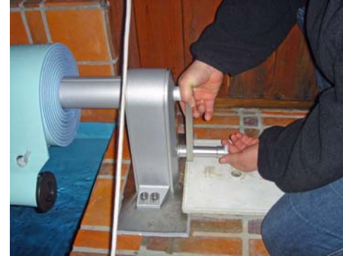
3. Kurbelgriff falls notwendig ganz herausziehen, bis er einrastet.
