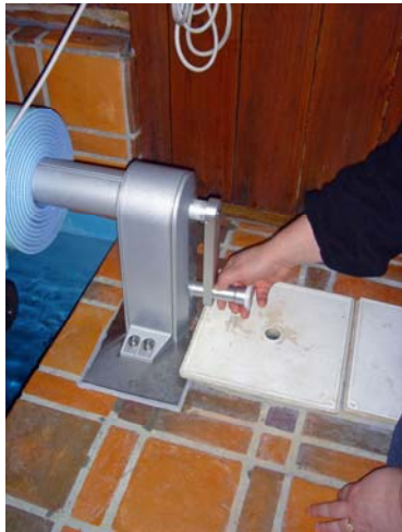
11. Kubelgriff vollständig herausziehen bis er einrastet.
